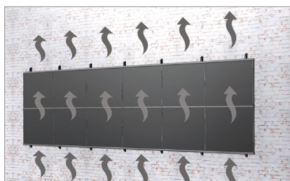
Buena ventilación trasera de los módulos
